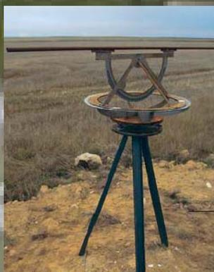
La dioptra era un instrumento topográfico utilizado por los romanos para trazar las calzadas.
